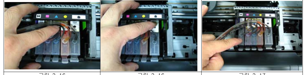
그림 3-16 그림 3-16 그림 3-17 손가락으로 왼쪽부분 3번째 카트리지의 윗부분을 눌러줍니다. 손가락으로 나머지 카트리지의 윗부분도 눌러줍니다. 손가락으로 왼쪽부분 카트리지의 아랫부분을 눌러줍니다.
