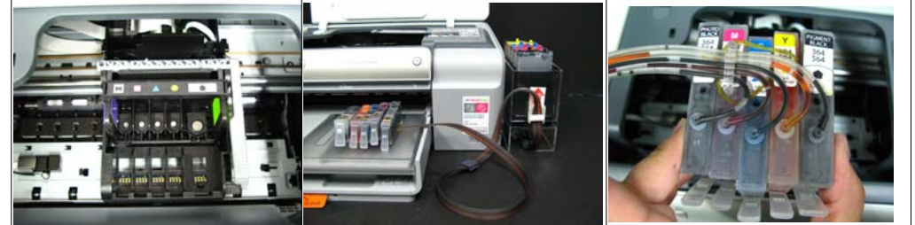
그림 3-10 그림 3-11 그림 3-12 헤드몽치에 헤드결합 완료 무한키트 TANK를 그림처럼 놓고, 카트리지도 그림처럼 놓습니다. 무한키트의 카트리지를 5개를 그림처럼 손으로 잡아줍니다.
