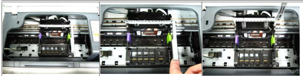
그림 3-4 그림 3-5 그림 3-6 헤드몽치를 프린터 가운데 가져옵니다 헤드몽치의 손잡이를 올려줍니다.
