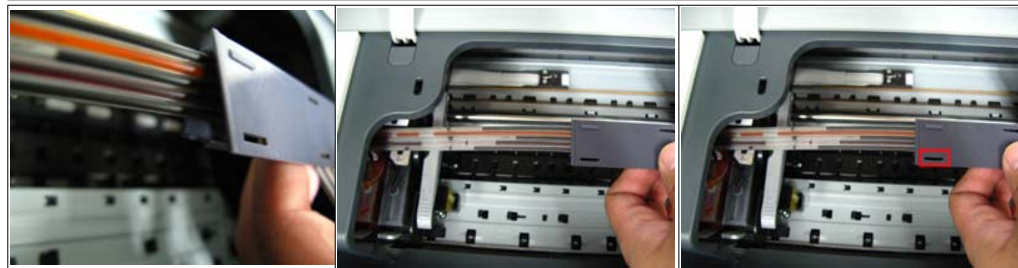
그림 3-33 왼쪽 옆에서 본 사진입니다. 그림 3-34 튜브를 일자가이드에 걸어준사진입니다. 그림 3-35 빨간색 네모박스를 손으로 다시눌러서 분리된 부분을 결합합니다.
