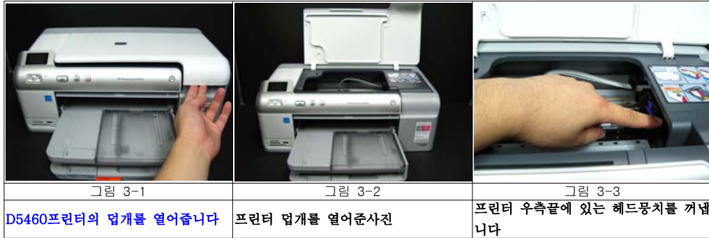
그림 3-1 그림 3-2 그림 3-3 D5460프린터의 덮개를 열어줍니다 프린터 덮개를 열어준사진 프린터 우측끝에 있는 헤드몽치를 꺼냅니다
