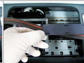
그림 7-8 그림처럼 손으로 누른부분이 분리됩니다.
