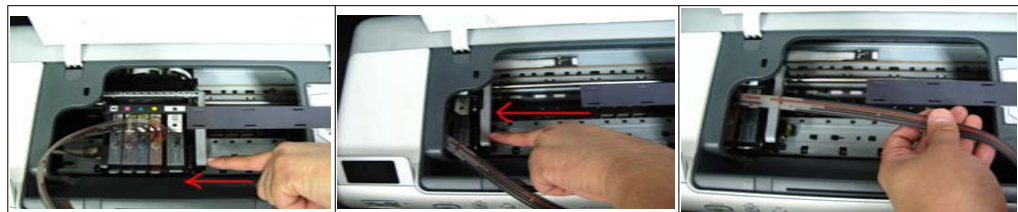
그림 3-30 프린터 헤드몽치를 그림처럼 왼쪽으로 밀어줍니다. 그림 3-31 그림처럼 끝까지 밀어줍니다. 그림 3-32 끝까지 밀어준 다음 튜브가 쏘이지 않게 일자가이드에 걸어줍니다
