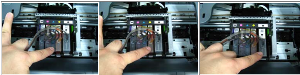
그림 3-18 손가락으로 왼쪽부분 2번,3번째 카트리지의 아랫부분으로 눌러줍니다. 그림 3-19 손가락으로 왼쪽부분 4번째 카트리지의 아랫부분을 눌러줍니다. 그림 3-20 손가락으로 왼쪽부분 5번째 카트리지의 아랫부분을 눌러줍니다.
