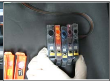
그림 7-12 평평한 곳에 그림처럼 카트리지를 뒤집어 놓습니다.
