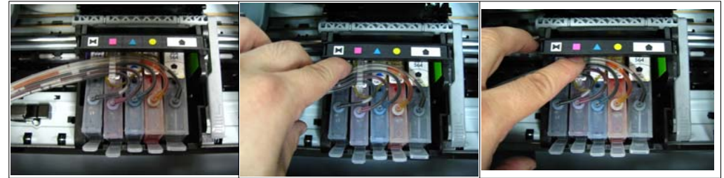
그림 3-13 그림 3-14 그림 3-15 무한키트의 카트리지를 5개를 그림처럼 프린터헤드에 장착합니다 손가락으로 왼쪽부분 카트리지의 윗부분을 눌러줍니다. 손가락으로 왼쪽부분 2번째 카트리지의 윗부분을 눌러줍니다.
