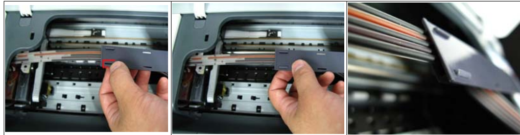
그림 3-36 손으로 눌러끼웁니다. 그림 3-37 눌러끼워서 완성한 사진입니다. 그림 3-38 왼쪽 옆에서 본 사진입니다.
