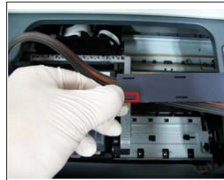
그림 7-7 일자가이드중 빨간네모박스 된부분을 손으로 눌러줍니다.
