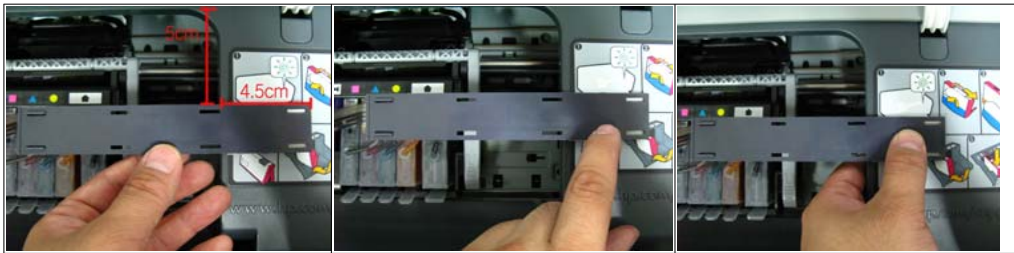
그림 3-24 프린터에 일자가이드를 부착할 위치입니다. 잘보시고 부착하세요 그림 3-25 정확한 위치에 부착합니다. 그림 3-26 엄지손가락으로 꼭 눌러줍니다.
