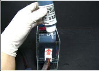
그림 6-3 인크를 쪽쪽 짜듯이 넣어줍니다. 인크탱크의 80%정도 까지만 충전합니다.
