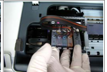
그림 7-6 카트리지 날개부분을 각각 눌러 카트리지를 헤드에서 살짝들어올라오게 눌러줍니다.
