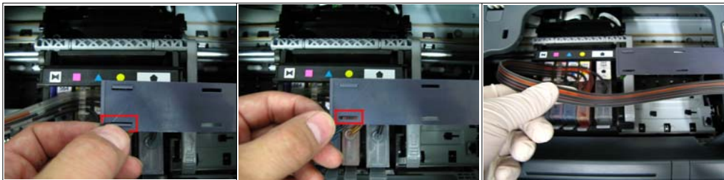
그림 3-27 빨간색 네모 박스된부분을 손으로 눌러 분리시킵니다. 그림 3-28 분리시켜준 사진입니다. 그림 3-29 프린터에 장착된 무한키트의 카트리지가 5개에 연결된 튜브를 그림처럼 쏘이지 않게 해줍니다.
