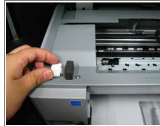
그림 7-1 프린터 덮개를 열고 센서가이드를 빼줍니다.
