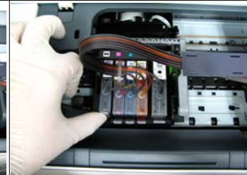
그림 7-5 일자가이드를 건드리지 않고 헤드몽치에서 카트리지를 뺄수있는 위치로 이동합니다.
